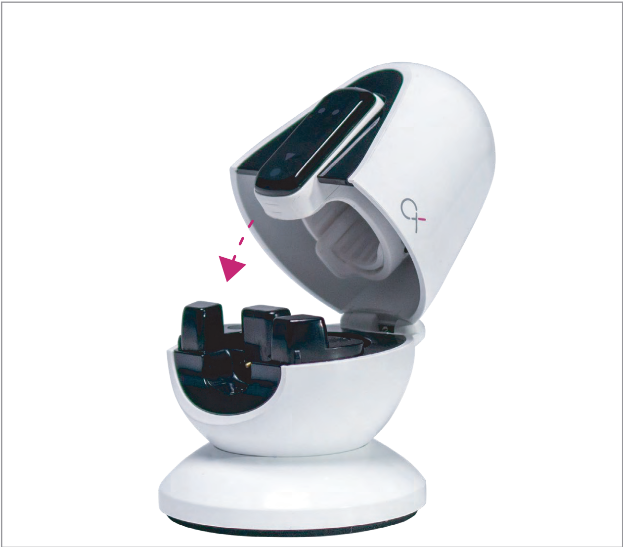
충전 크래들에 링 디바이스를 연결 할때 링 디바이스의 방향에 주의해 충전 크래들 윗 뚜껑 홈에 끼워주세요, 그리고 뚜껑을 닫으면 충전이 시작됩니다.
